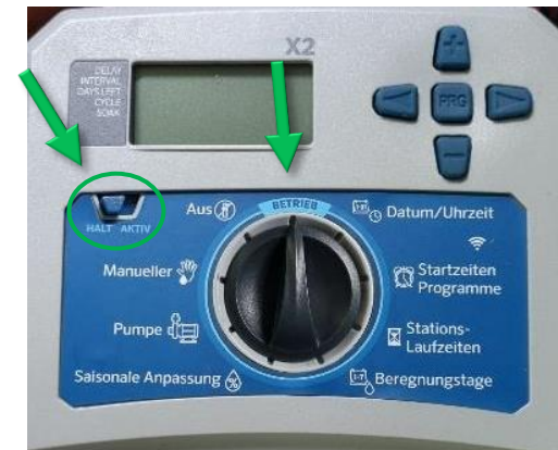
Winter-Einstellung: Computer aktiv, Regensensor-Schalter auf „Bypass“
